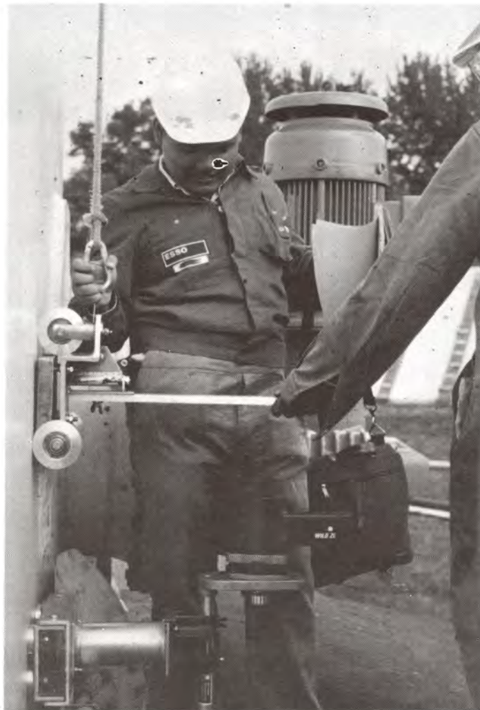
รูปที่ 103 ดูเข้าใกล้กันอีกนิด ชุดกล้องส่อง (Precision optical plummet) กับชุด movable scale assembly
