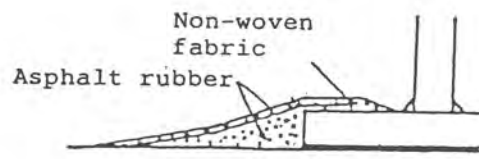
รูปที่ 33 ตัวอย่างวิธีป้องกันและระบายน้ำฝนออกจากบริเวณกันถึงสำรอง
