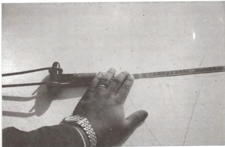
รูปที่ 97 สายเทปวัดแนบกับตัวผนังถึงและเริ่มต้นที่ “ศูนย์”
