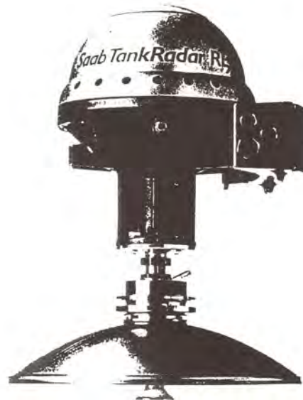
รูปที่ 154 Radar Level gauging ชนิด parabolic antenna
