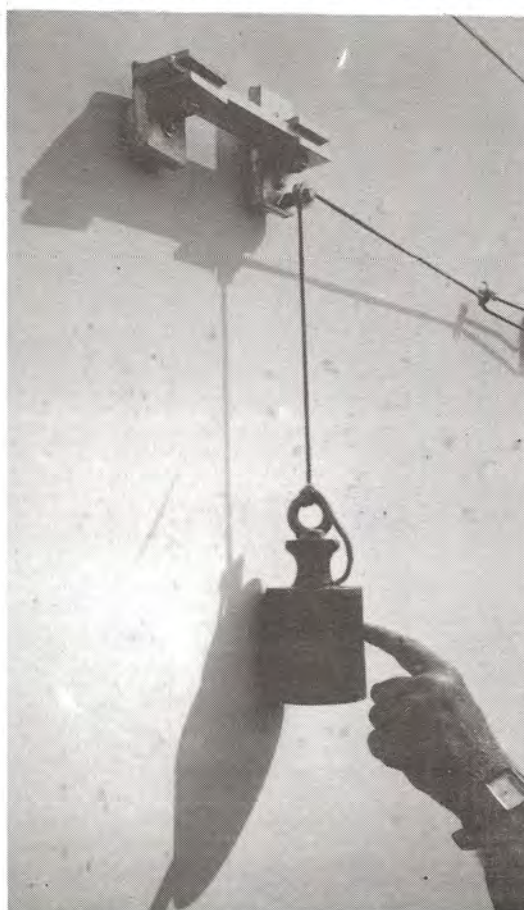
รูปที่ 93 ปลายสายเทปวัดซึ่งเริ่มต้น “ศูนย์” ถูกถ่วงด้วยตุ้มน้ำหนักถ่วง 5 กก เพื่อรักษาความตึงของสายเทปให้เท่ากันทุกครั้งที่ทำารวัด แต่ละส่วนของเส้นรอบวงภายนอกถึงสำรวจ
