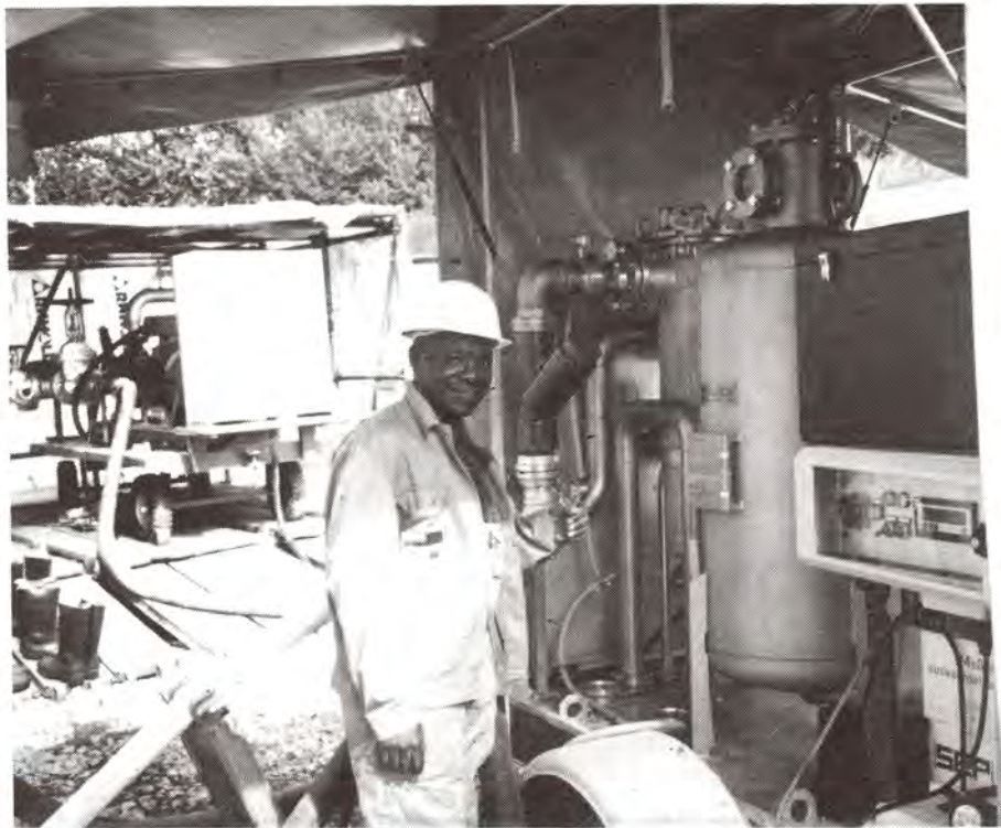
รูปที่ 85 ช่างหลังจะเป็นปั้มน้ำขับด้วยเครื่องยนต์ดีเซล ใช้ในการสูบน้ำออกจากถังสำรองหรืออาจใช้ดูดน้ำจากแหล่งน้ำสำรองอื่นๆ
